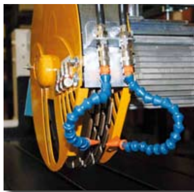
MULTIPLE BLADES FOR PROCESSING ANTI-SLIP GROOVES ▶ Utilizzo di più dischi per lavorazioni antisdrucchio
